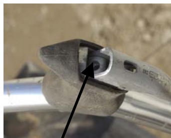
Sportsgreb med skjult kabel-føring. Sliddet er under den markerede runde bro med hul til plomben. Svært at se.
