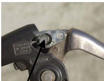
Pilen viser hvor på mtb-grebet kablet vil slides. Fejlen kan nemt ses ind fra siden.
